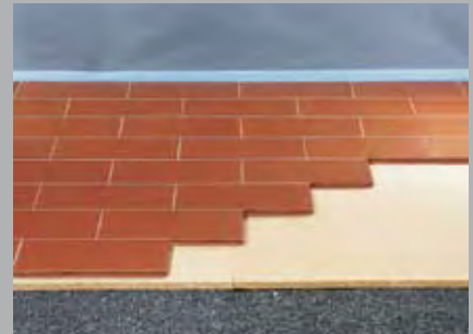
„ESTRICHZIEGEL“ auf Holzweichfaser-Trittschalldämmung (z.B. PAVATEX „PAVAPOR 22/21“ oder 17/16“) auf CREATON-Trockenschüttung.
