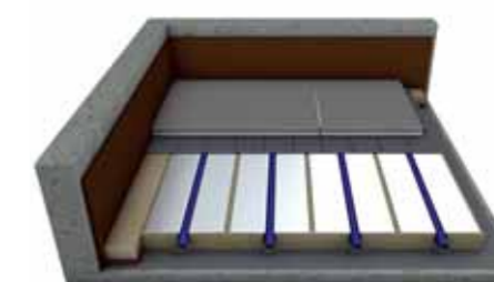
„ESTRICHZIEGEL“ na otestovanom systéme podlahového kúrenia zhotovovaného za sucha (lykové vlákno)
